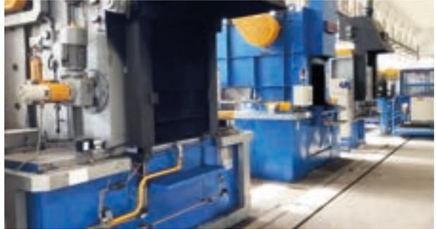
Centro freni per controllo coppie - *Torque control brake center*
